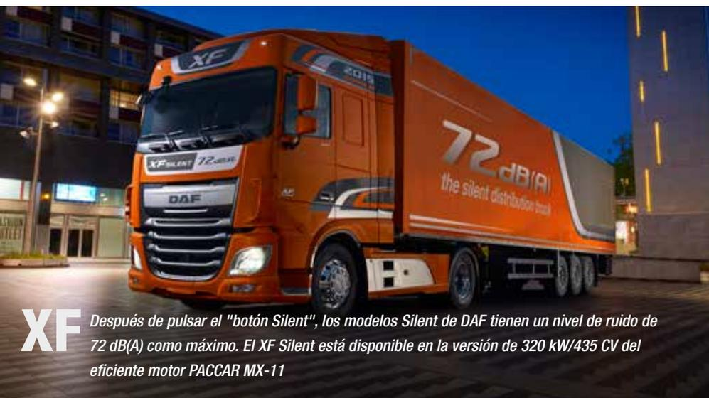
**XF** Después de pulsar el "botón Silent", los modelos Silent de DAF tienen un nivel de ruido de 72 dB(A) como máximo. El XF Silent está disponible en la versión de 320 kW/435 CV del eficiente motor PACCAR MX-11
