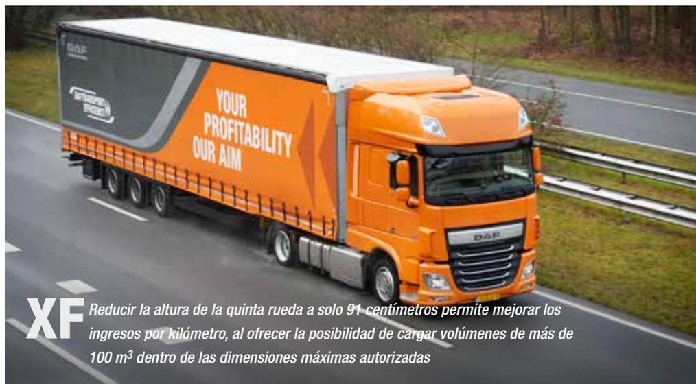
**XF** Reducir la altura de la quinta rueda a solo 91 centímetros permite mejorar los ingresos por kilómetro, al ofrecer la posibilidad de cargar volúmenes de más de 100 m<sup>3</sup> dentro de las dimensiones máximas autorizadas
